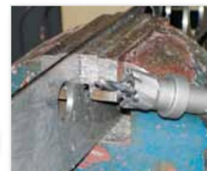
Ручное сверление до Ø 30 мм
