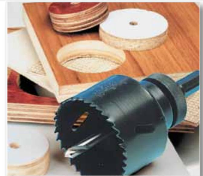
Увеличение имеющихся отверстий: имеющееся отверстие 32 мм или большего диаметра может быть увеличено с помощью простого приема: возьмите 32 мм круговую ножовку и установите внутрь круговой ножовки, нужного Вам диаметра, на резьбу державки A2. Эта внутренняя ножовка действует как центр для расширения существующего отверстия (см. фото).
