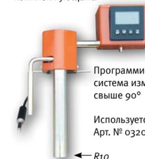
Программируемая цифровая система измерения угла гибки свыше 90°
