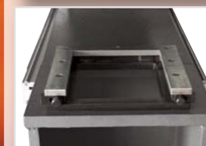
Держатель для матрицы, возможна смена инструмента даже при заложной в пресс двери распределительного шкафа
