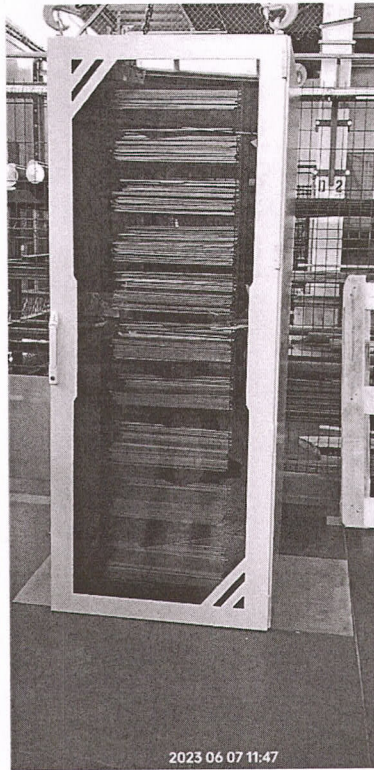
Рисунок 2.8. Внешний вид шкафа после нагрузки и испытаний 2024 кг
