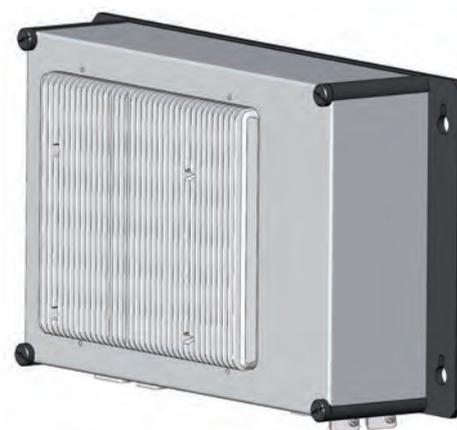
Коробочный ПК, с пассивным охлаждением
