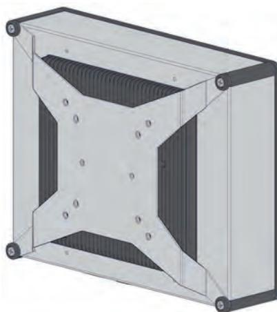
Корпус с монтажными отверстиями стандарта VESA2 и встроенным пассивным охлаждением
